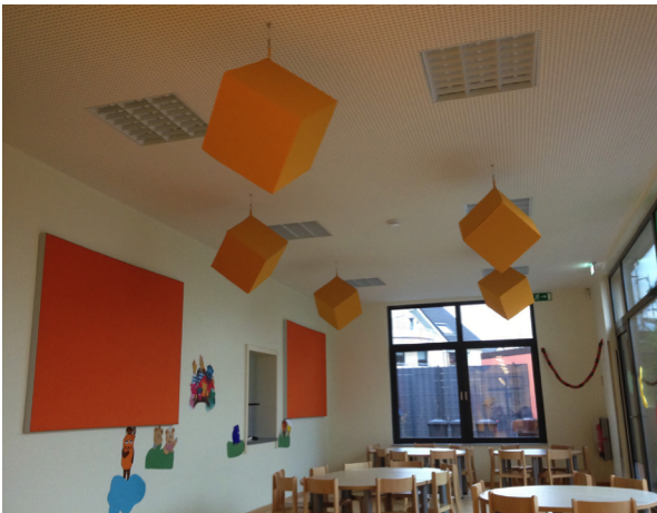
Abbildung 3.1: Schallabsorbierende Wandelemente und Raumelemente in Würfelform (Foto: raumAKUSTIKS)
